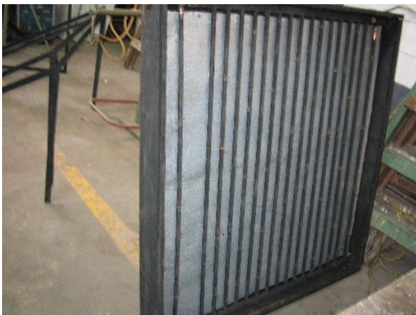
Colector armado antes de pintar
