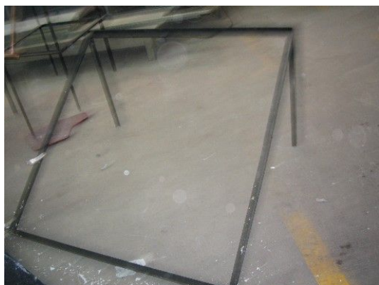
Armazón para colector (Se muestra uno de 1.22 x 1.22 mts). En la foto no se muestran los dos travesaños.
