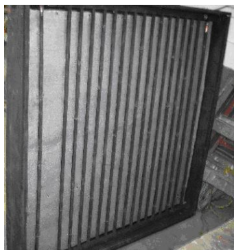
Foto 3. Colector con forma de radiador con cabezales perforados con punzón y unidos con soldadura, los tubos de los extremos se unieron con T's.
