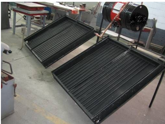
Colectores armados y pintados de negro mate
