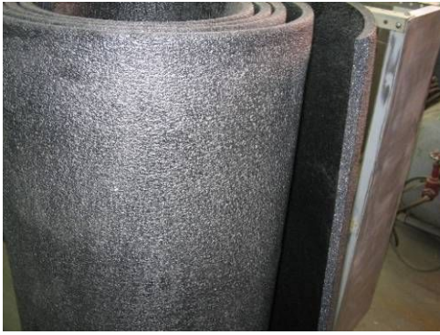
Aislante térmico de neopreno
