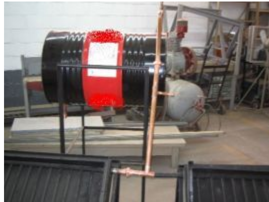
Foto 10 Termotanque sellado de lámina negra durante su construcción.
