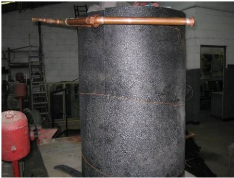
Termotanque forrado (En la imagen está amarrado con alambre de cobre pero es más sencillo amarrarlo con rafia)
